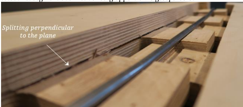
Figuur 4-6: bezweken verbinding door het splijten van het hout
