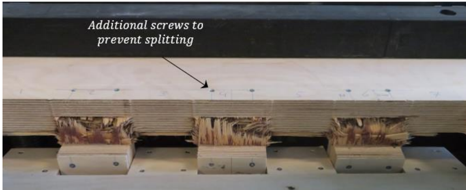
Figuur 4-7: bezweken verbinding door een buigend moment in de vingers
